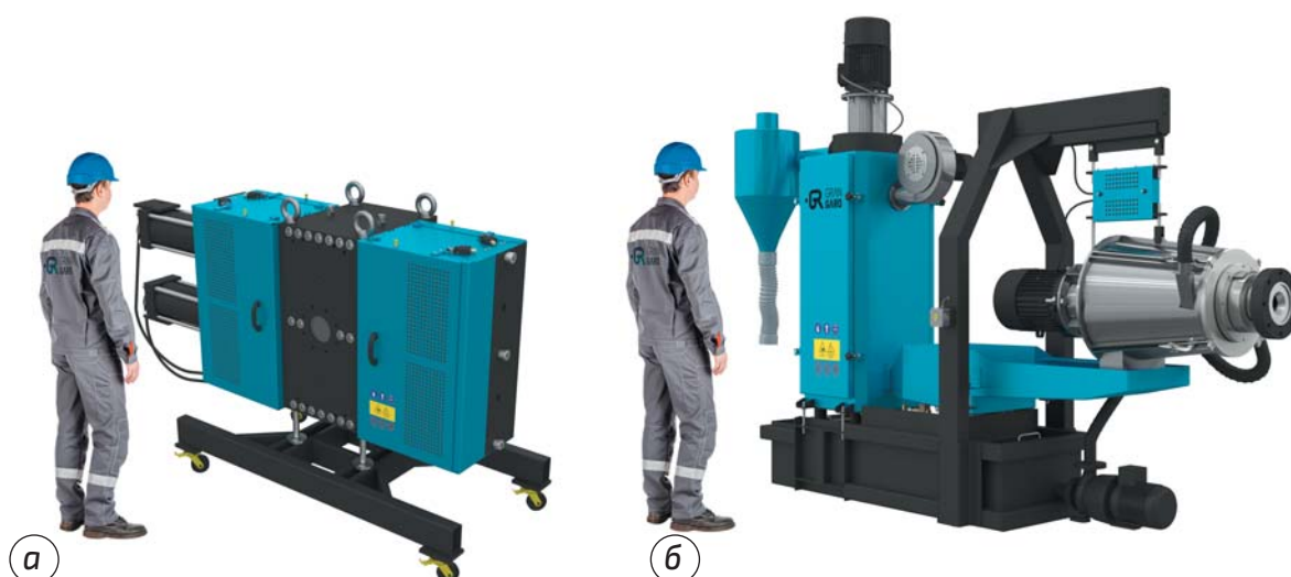
◀ РИС. 6. Шиберный фильтр со сменными сетками (а) и водокольцевой узел резки (б)
