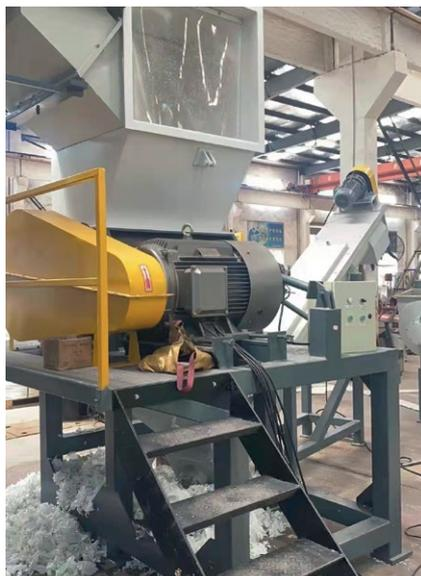
**Дробилка с электродвигателем мощностью 55-75 кВт, длиной ротора 1000 мм**
