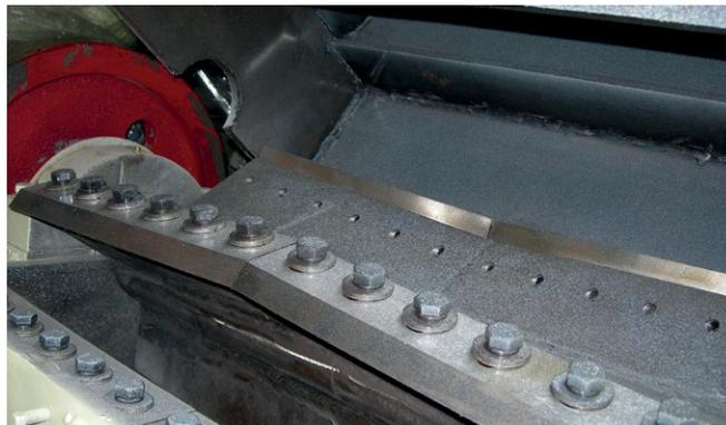
**Ротор дробилки с ножами типа «ласточкин хвост»**
